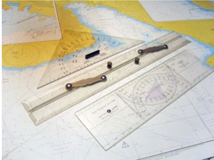
Quelques instruments utilisés en mer : Règle de Cras, règle parallèle, triangle rapporteur ( http://fr.wikipedia.org/wiki/Fichier:Navigational_rules_types.JPG )
