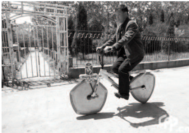
Roues en formes de « polygones de Reuleaux » à diamètres constants.
