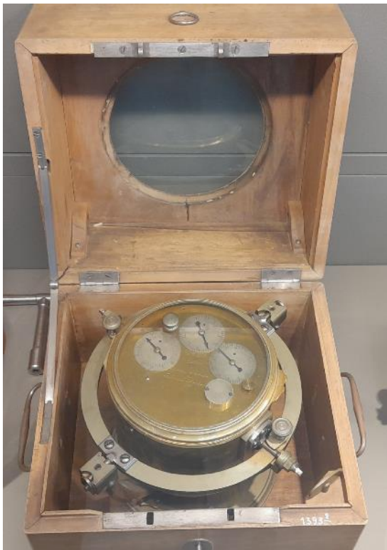
Montre marine n° 3 par Ferdinand Berthoud, 1776 (trois cadrans donnent les heures, minutes et secondes) – Musée des Arts et Métiers.
