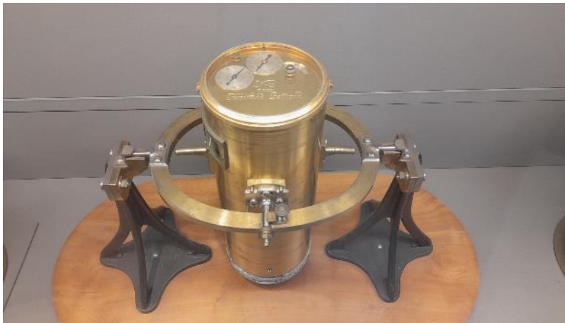
Horloge marine n° 11 à poids moteur par Ferdinand Berthoud, 1773 Musée des Arts et Métiers.
